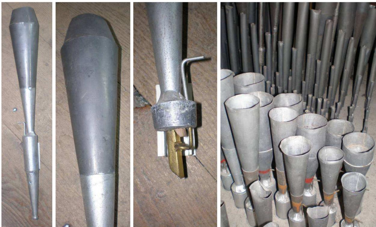
*Sopra: immagini del Fa#2 del Clarone bassi, con dettaglio della tuba e dell'ancia. A destra, le canne minori di Tromba soprani (ad anima), Violoncello 16 soprani e Corno Inglese soprani. Notare la banda colorata sulle tube per segnalare l'altezza corretta delle grucce. Le caratteristiche tecniche delle ance richiamano da vicino quelle serassiane.*
